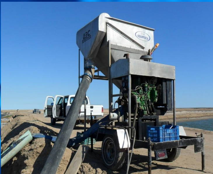
Figura 11.- La maquina cosechadora debe ser limpiada después de cada uso para evitar la descomposición de residuos de la cosecha y la contaminación del producto.
