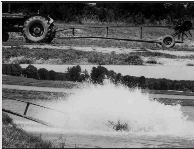
Figura 1. Un aireador mecánico movido por tractor.
